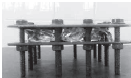
شکل ۲. نمونه و قالب بعد از فشردگی
